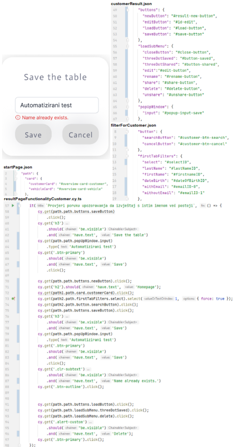
Slika 27. Testiranje poruke upozorenja za izvještaj s istim imenom
