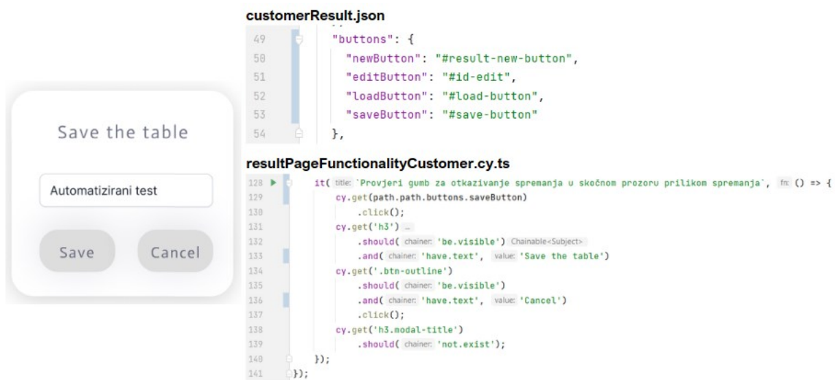
Slika 25. Testiranje funkcionalnosti otkazivanja radnje spremanja izvještaja
