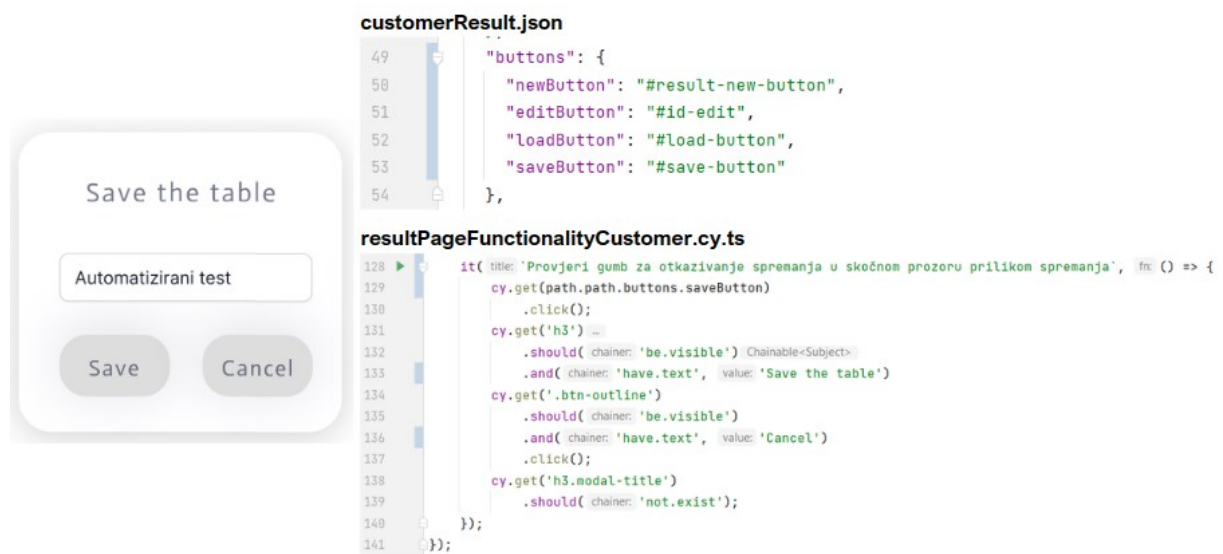
Slika 25. Testiranje funkcionalnosti otkazivanja radnje spremanja izvještaja
