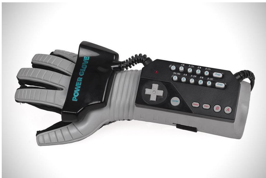
Slika 3. fotografija Nintendo PowerGlove-a, jedan od prvih komercijalnih sustava „virtualne“ stvarnosti
