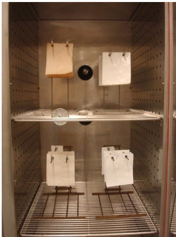
Slika 1. Starenje premazanih papira u pećnici. 36
