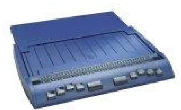
Slika 4. Brailleova elektronička bilježnica
