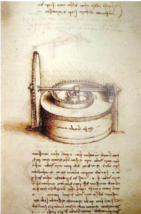
Studija mehaničke snage opruge, L. da Vinci, 1493. do 1497. godine.
