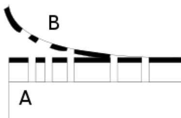
**Slika 10.** Princip obojenja kod visokog tiska<sup>25</sup>
