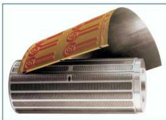
Prilog 5. Slika magnetnog valjka sa formom za knjigotisak 97
