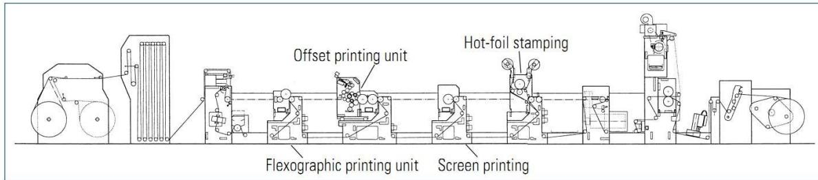
**Slika 26.** Hibridni tiskarski stroj za varijabilni otisak uz dodatno oplemenjivanje<sup>89</sup>
