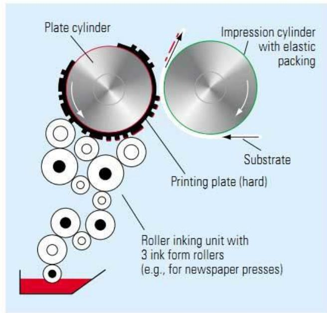
**Slika 12.** Princip rada stroja za knjigotisak<sup>29</sup>
