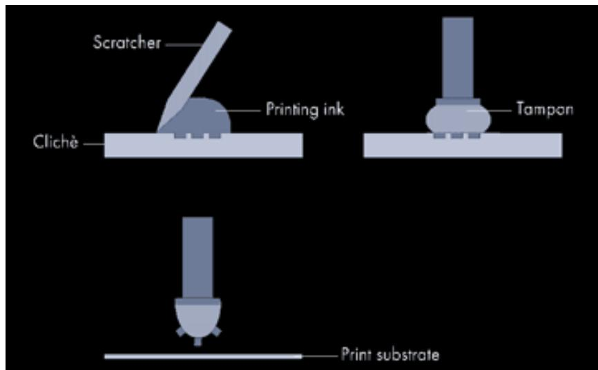
**Slika 16.** Princip rada tampon tiska<sup>37</sup>
