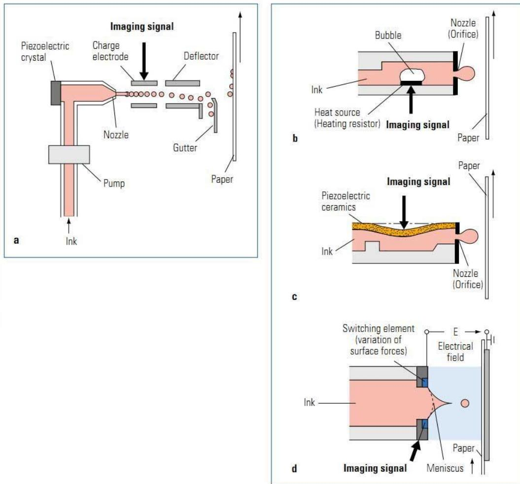
**Slika 23.** Principi funkciranja Ink-jet tehnologija. a - neprekidni ink-jet, b - drop-on-demand ink-jet, c - drop-on-demand piezoo ink-jet, d - elektrostatički ink-jet<sup>49</sup>
