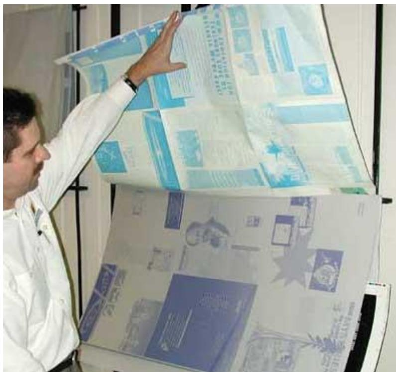
**Slika 3.** Razvijena offsetna tiskovna forma u negativu (na slici radnik provjerava pravilnu poziciju montaže na formi pomoću papira koji se oboji u plavo)<sup>7</sup>
