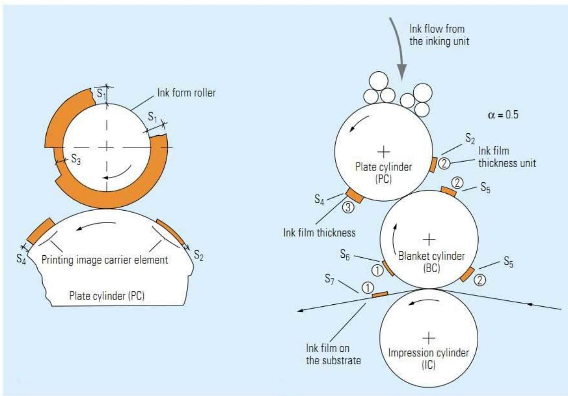
**Slika 2.** Indirektni način prijenosa obojenja na tiskarsku površinu<sup>4</sup>
