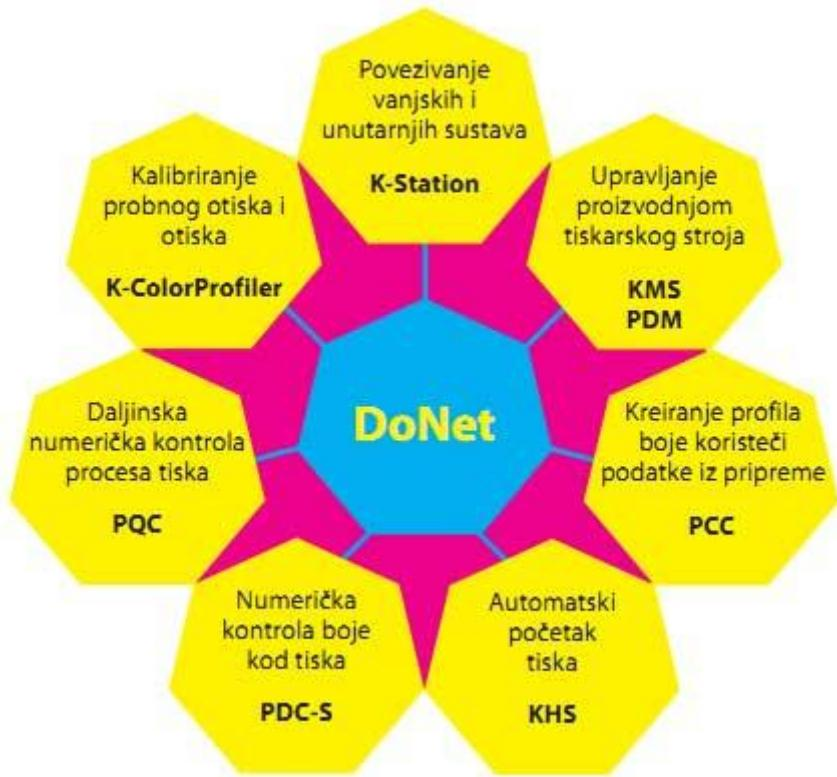
Slika 28. Shema Donet sustava kakvoga je razvila tvrtka Komori<sup>92</sup>
