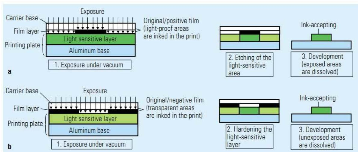
**Slika 4.** Izrada tiskovnih formi u a - pozitivu i b- negativu<sup>10</sup>
