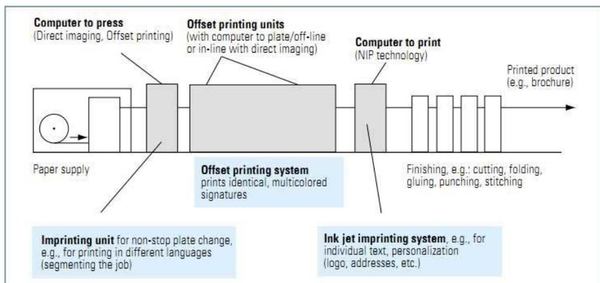
**Slika 25.** Dijelovi sustava hibridnog tiskarskog stroja za otiskivanje personaliziranih medija<sup>86</sup>
