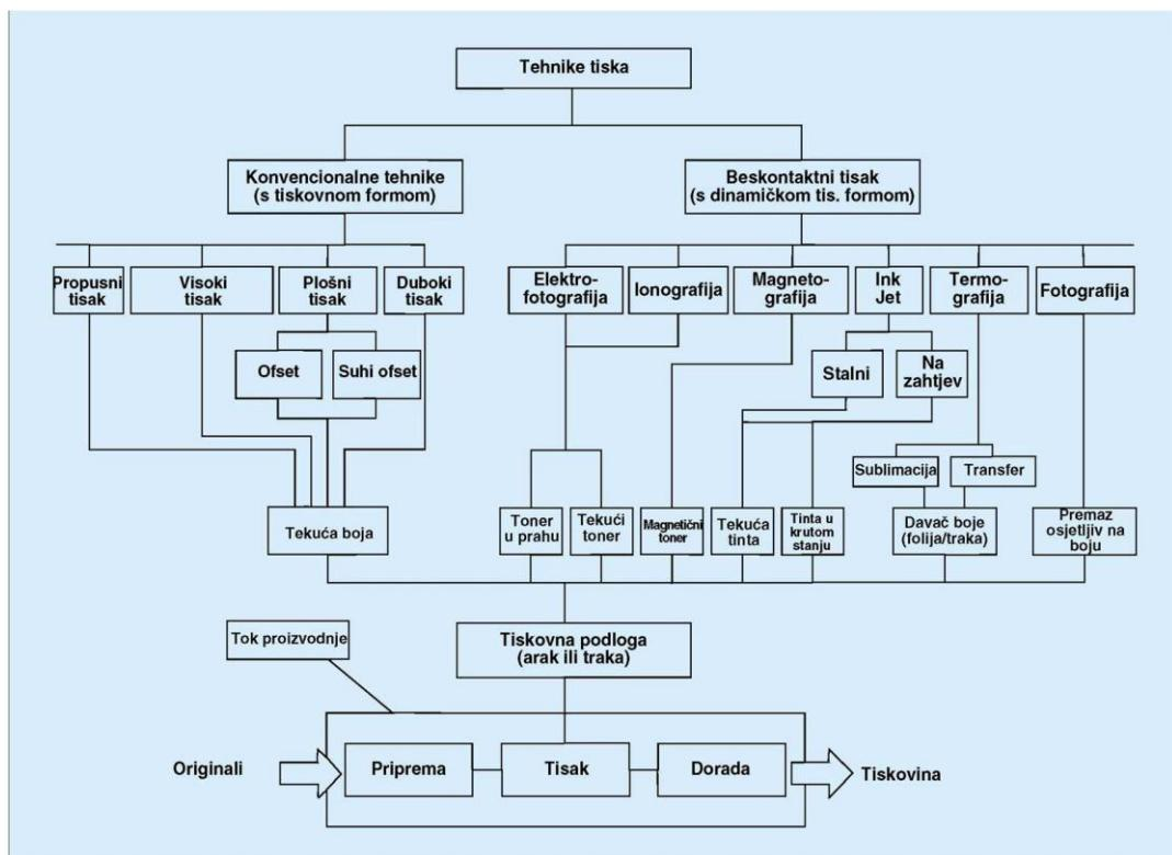
Slika 8. Podjela tiskovnih tehnika<sup>23</sup>
