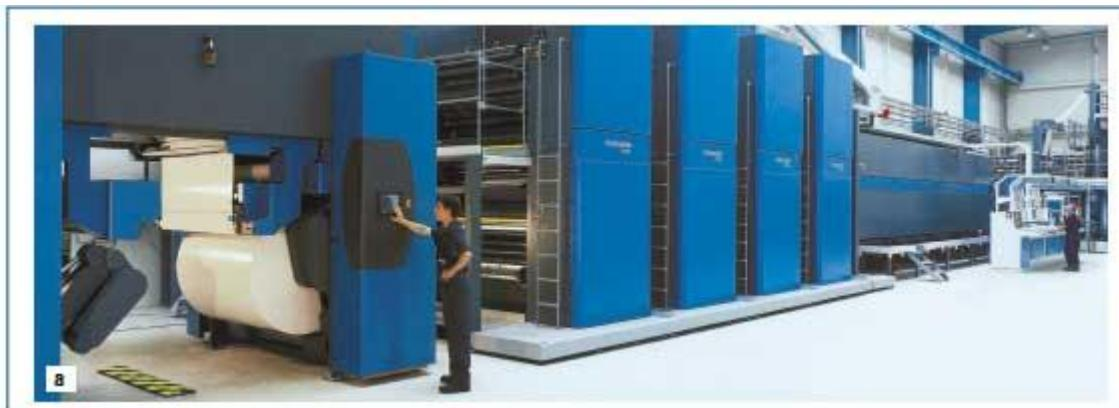
Prilog 4. Slika komercijalnog offsetnog stroja<sup>96</sup>
