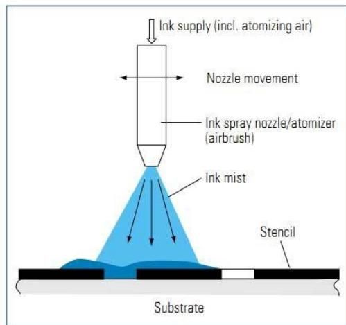
**Slika 18.** Princip tiskanja uz pomoć matrice<sup>44</sup>
