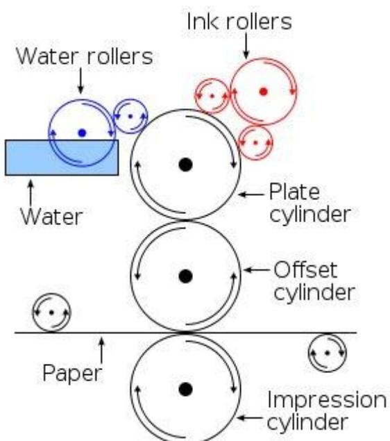
Slika 20. Princip rada offsetnog tiska<sup>46</sup>
