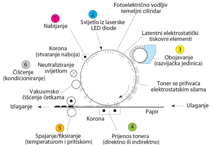
**Slika 21.** Princip rada elektrofotografskog stroja<sup>47</sup>
