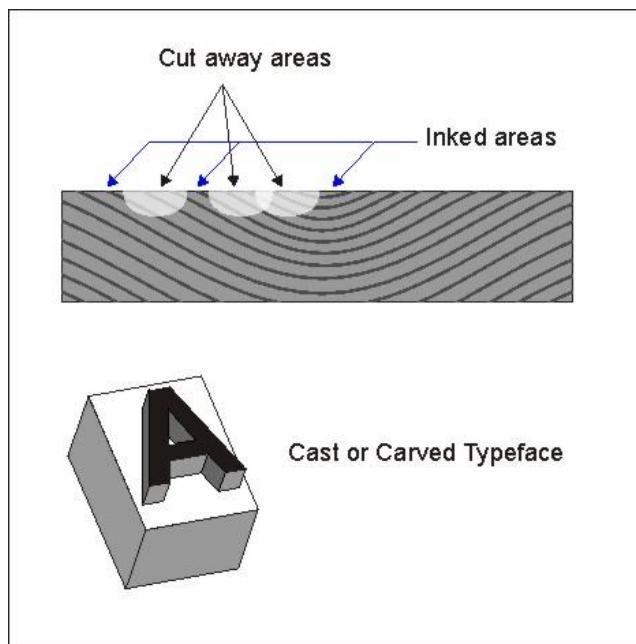
**Slika 9.** Princip obojenja izbočenih površina tiskovne forme kod visokog tiska koje dalje prenose obojenje na tiskovnu površinu<sup>24</sup>
