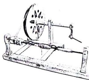
Slika 18. Na slici je vidljiv *čekrk*, drvena naprava koja služi za namotavanje pređe.
