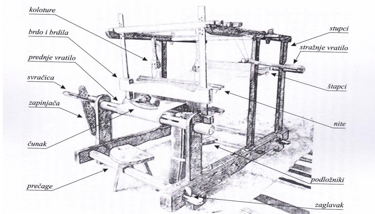
Slika 24. Na slici je prikazan *tkalački stan*, drvena naprava za tkanje, i njegovi dijelovi.
