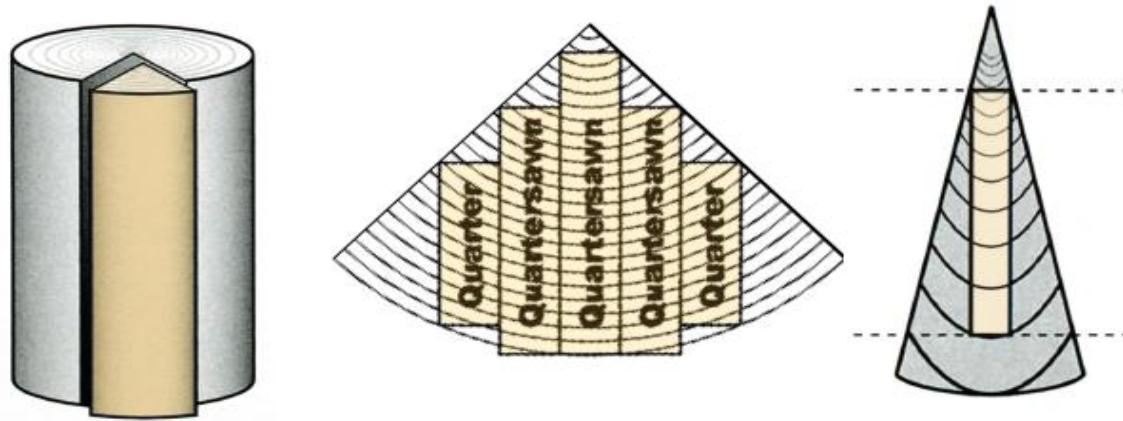
Slika 9. Način dobivanja drvenih pločica<sup>90</sup>
