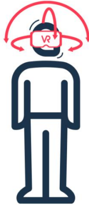
Slika 1. ilustracija tri stupnja slobode
