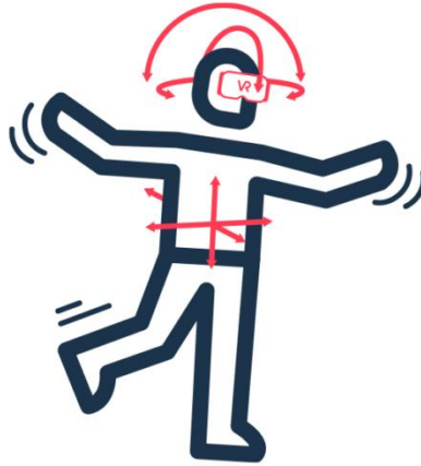
Slika 2. ilustracija šest stupnjeva slobode
