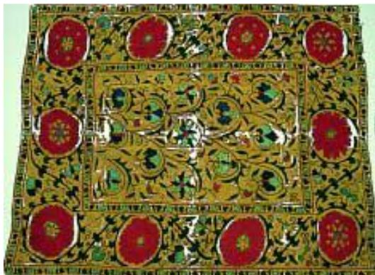
Slika 7. Prikaz oštećenog tekstilnog materijala na površini svjetlosne kutije koja omogućuje lakše uočavanje oštećenih mesta (reCollections: Caring for Collections Across Australia)
