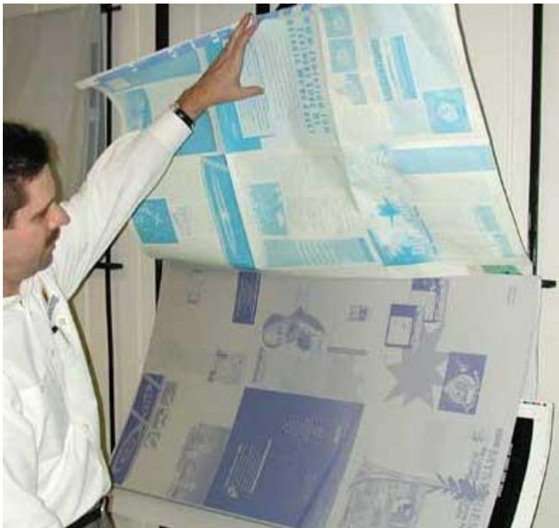
Slika 3. Razvijena offsetna tiskovna forma u negativu (na slici radnik provjerava pravilnu poziciju montaže na formi pomoću papira koji se oboji u plavo) 7
