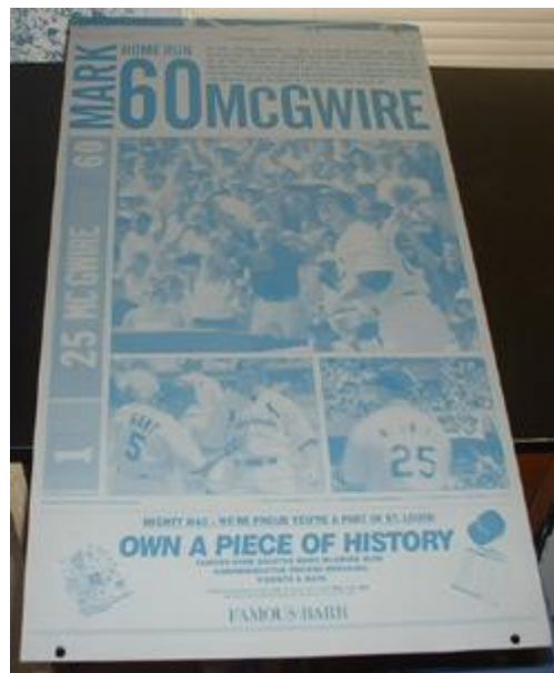
Slika 6. Tiskovna forma za offsetni tisak 12
