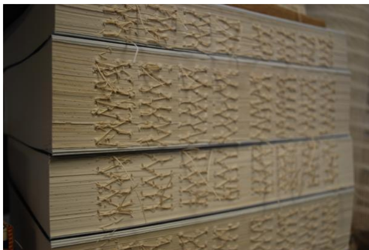
Slika 6. Uvezivanje slobodnih listova šivanjem 86
