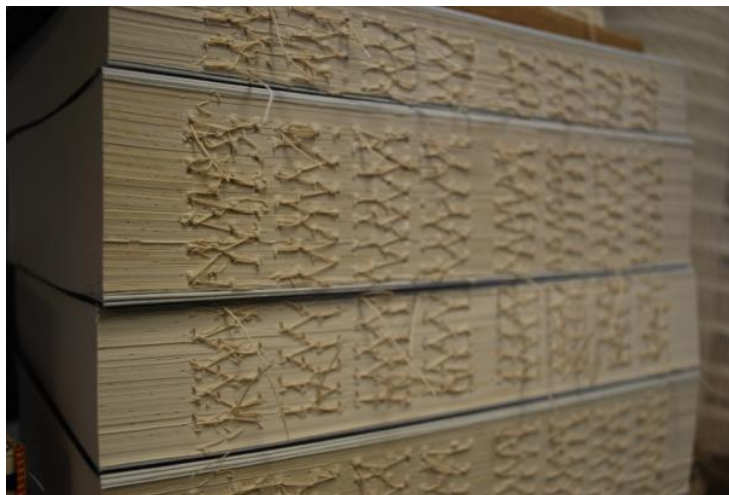
Slika 6. Uvezivanje slobodnih listova šivanjem 86
