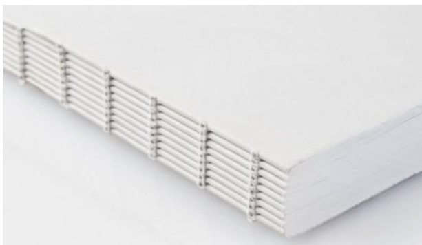
Slika 7. Uvezivanje knjižnih slogova šivanjem jednog s drugim
