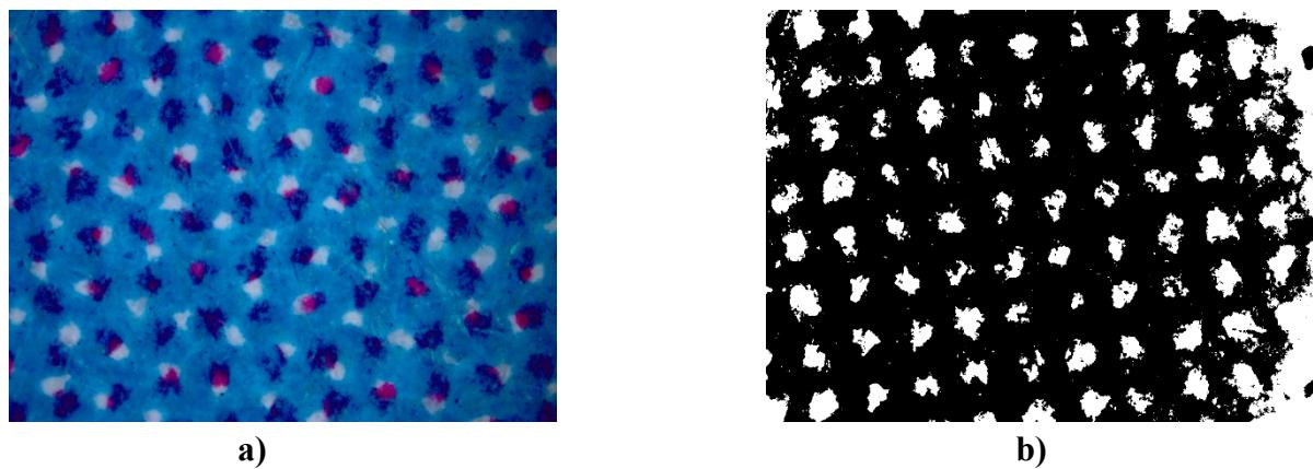
**Slika 6.** Digitalna slika uzorka snimana pod reflektirajućom svjetlosti s najmanjim postotkom prekrivnosti plavom bojom **a)** prije analize u programskom rješenju i **b)** nakon analize u programskom rješenju.
