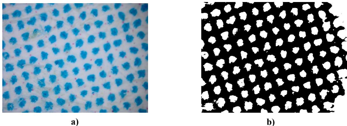
**Slika 7.** Digitalna slika uzorka snimana pod prolaznom svjetlosti s najmanjim postotkom prekrivnosti plavom bojom **a)** prije analize u programskom rješenju i **b)** nakon analize u programskom rješenju.
