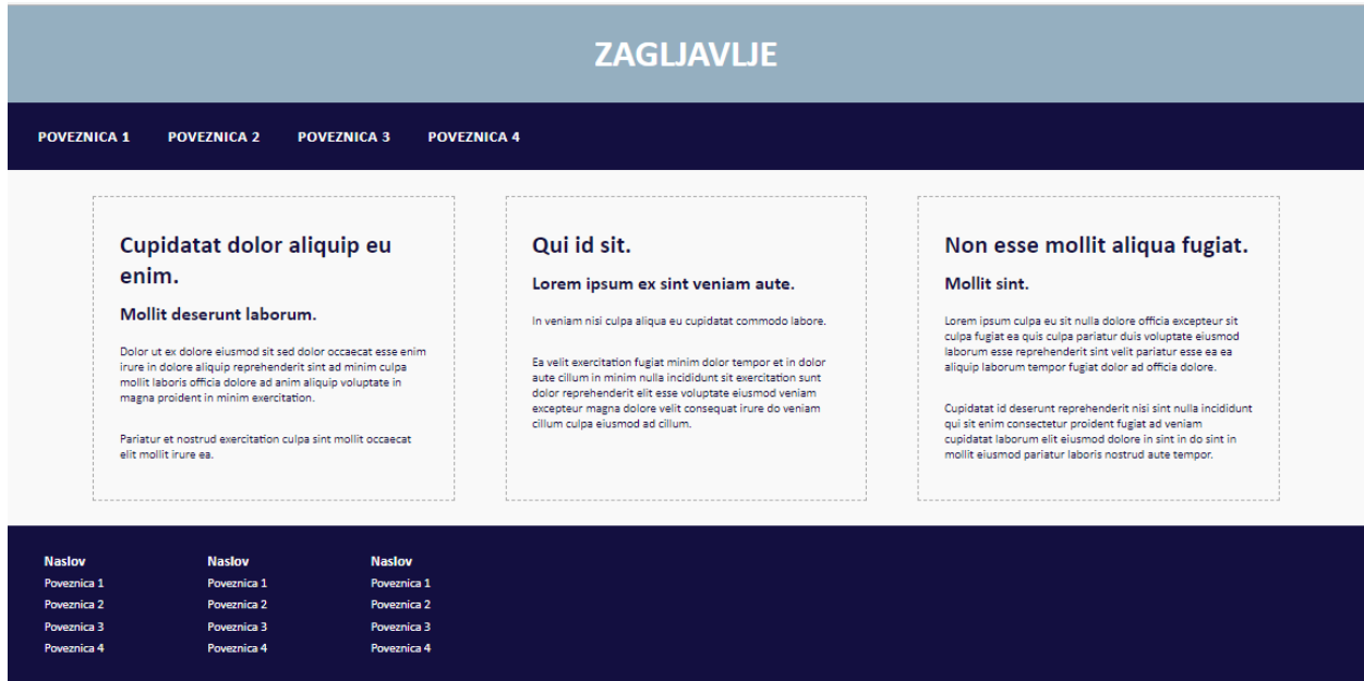
Slika 15. Primjer rasporeda korištenjem grid-template-areas svojstva
