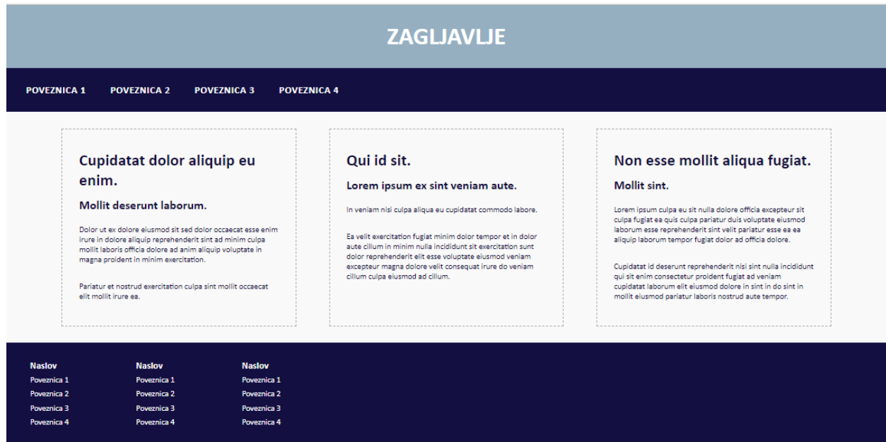
Slika 15. Primjer rasporeda korištenjem grid-template-areas svojstva
