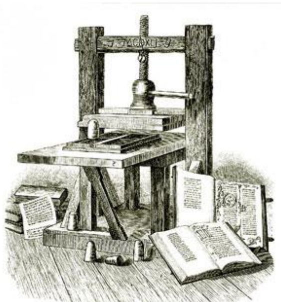
Slika 1. Gutenbergov tiskarski stroj
