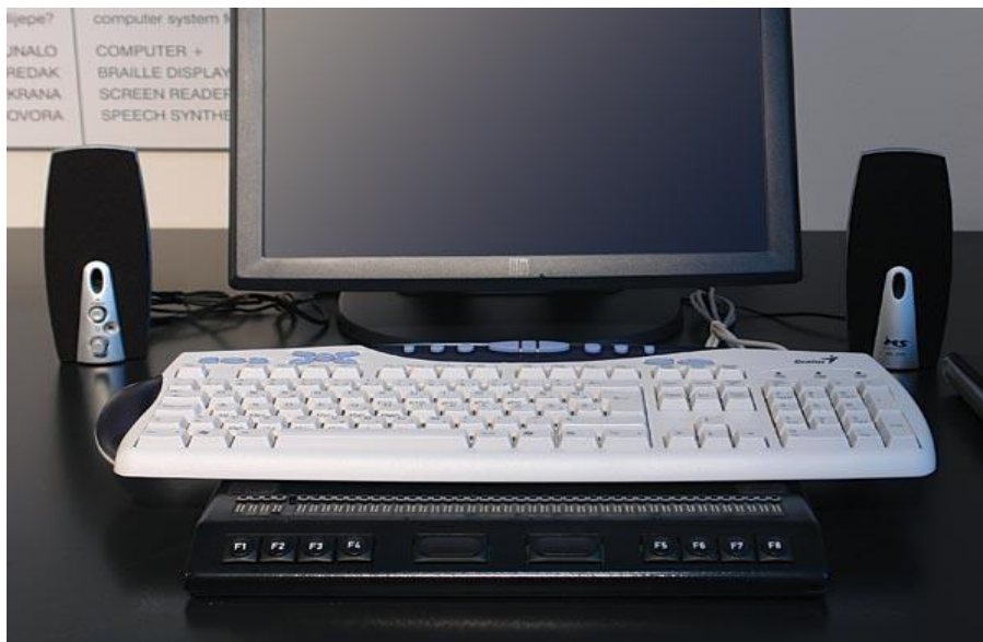
Slika 3. Brailleov redak priključen na osobno računalo
