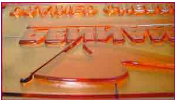
Slika 5. Izgled fleksografske tiskovne forme 11
